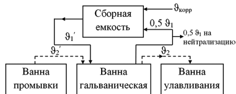
Рис. 2. Корректирующие потоки в технологической схеме нанесения многослойных покрытий
